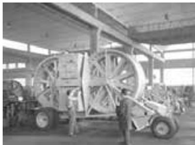
Brevetto Edison per il primo sistema di tesatura frenata
