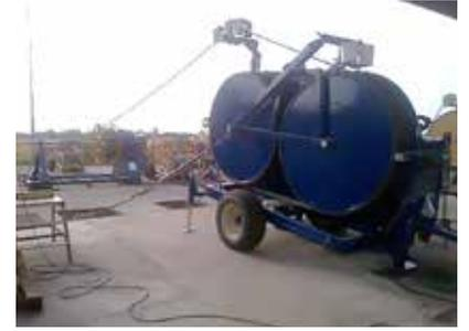
Freno per tesatura con elicottero a 20 km/h con 4 livelli di sicurezza
