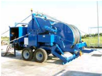
Introduzione del concetto "Dual Machine" per la tesatura aerea e sotterranea
